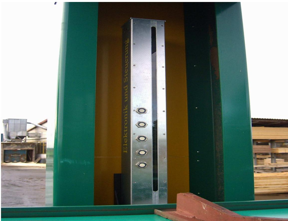
3D Messung mit Ermittlung des kleinsten Durchmessers (Rotierende Kluppe)
